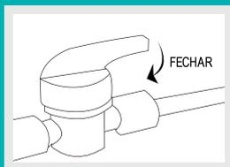
1. Feche a válvula de serviço do purificador. Remova a tampa do purificador e vire-a para ter acesso ao refil.
