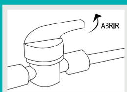
4. Abra a válvula de serviço do purificador e após, certifique-se de que não há vazamentos. Em seguida, deixe correr 15 litros de água para liberar o pó do carvão.
