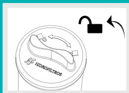
2. Gire o refil ¼ de volta seguindo a indicação da sua tampa e desencaixe-o do purificador.
