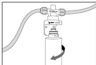
**1. IMPORTANTE:** Não é necessário fechar o registro geral para a troca do refil, pois o Cap Facile® possui uma válvula automática de bloqueio de água. Utilize um pano e um recipiente para coletar a água entre a saída do Cap Facile® e a torneira. Desencaixe o Refil Purificador Facile® girando 1/4 de volta para a esquerda.
