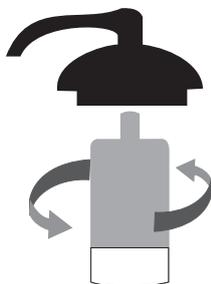
2 - Faça a substituição do elemento filtrante. Verifique a posição do anel de vedação (caso haja). Certifique-se que o novo elemento está devidamente rosqueado na tampa.
