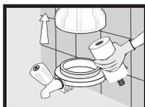
4 - Com uma luva, desenrosque o elemento filtrante cheio de impurezas. Lave a tampa e o copo do filtro com água e sabão biodegradável.
