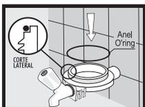
5 - Observe se o anel o'ring utilizado para a vedação do filtro está devidamente alojado na tampa (cód. 2237-70B). Não utilize fita veda rosca na tampa do filtro.
