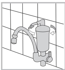
1. Feche a torneira do filtro. Desenrosque a tampa para a retirada do elemento filtrante que fica preso nela. Você também pode retirar o copo do filtro para limpá-lo.
