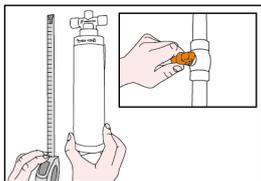
**1.** Escolha um local de fácil acesso para instalar o Purificador Multi Facile®. Feche o registro de água anterior ao ponto de instalação desejado. Abra a torneira e descarte a água da tubulação.
