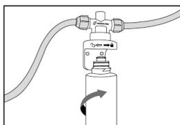
**4.** Encaixe o Refil Purificador Facile® e gire 1/4 de volta para a direita.
