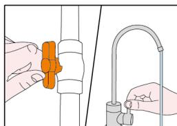
**5.** Garanta que todas as conexões estejam livres de vazamento, conferindo os componentes de vedação. Abra o registro geral de água. Descarte os primeiros 15 litros até que a água fique cristalina. Uau! Agora você pode desfrutar de uma água purificada.
