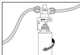
**1. IMPORTANTE:** Não é necessário fechar o registro geral para a troca do refil, pois o Cap Facile® possui uma válvula automática de bloqueio de água. Utilize um pano e um recipiente para coletar a água entre a saída do Cap Facile® e a torneira. Desencaixe o Refil Purificador Facile® girando 1/4 de volta para a esquerda.
