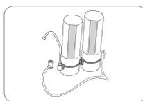
2 - Escolha o local para instalar o purificador. Você pode instalar sobre a pia ou fixado na parede.
