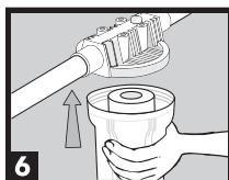
Encaixe o novo elemento filtrante dentro do copo e enrosque o copo de volta na tampa. Abra novamente o registro do hidrômetro.
