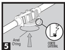
Observe se o anel o'ring utilizado para a vedação do filtro está devidamente alojado na tampa (cód. 2237- 70B).
