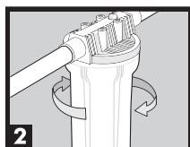
Desenrosque o copo do filtro. Utilize a chave se necessário [segure com uma das mãos o filtro, para não danificar a tubulação].
