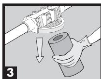
Com uma luva, retire o elemento filtrante cheio de impurezas.
