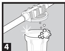
Faça uma limpeza do copo e da tampa do filtro. Utilize apenas água e sabão biodegradável. Evite materiais abrasivos.
