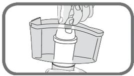
1 - Mergulhe o refil por 15 minutos em água fria (entre 10°C e 15°C), após instale conforme a imagem.
