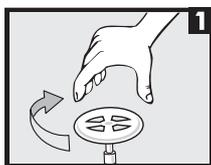
**1** Feche o registro do hidrômetro. Você pode instalar o filtro antes da caixa d'água, junto ao cavalete (após o hidrômetro) ou em piscinas.
