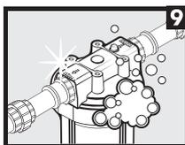
**9** Faça rotineiramente a limpeza da tampa e do copo do filtro. Utilize apenas sabão biodegradável. Evite materiais abrasivos. **IMPORTANTE!** Verifique periodicamente a necessidade de limpeza do elemento filtrante. Utilize apenas água e escova macia.
