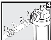
**4** Em um dos lados da união (1) cole o cano de entrada da água, do outro fixe um pedaço de cano (2) (medida de 5 cm - o tamanho dependerá da instalação). Cole na outra extremidade do cano o adaptador soldável (3) (lado liso). Faça o mesmo encaixe de peças no outro lado do filtro.
