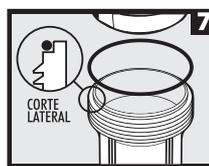
**7** Encaixe o copo do filtro observando se o anel o ring está devidamente encaixado no copo (cód.2358-70B). **IMPORTANTE!** Rosqueie o copo com a chave até o final da rosca. Este aperto é o suficiente para que o anel de vedação seja comprimido, evitando vazamentos. Não utilize fita teflon (veda-rosca) no copo do filtro.
