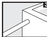
**3** Seccione o cano de entrada da água. Observe qual a posição que o filtro será instalado para dimensionar o espaço necessário.
