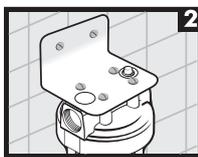
**2** Dimensione o local da instalação para fixar o suporte do filtro.
