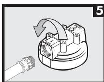
**5** Encaixe e gire a tampa do filtro nos adaptadores até ficar bem presa. Observe as indicações de entrada e saída na tampa. Importante, sempre utilize fita de teflon (vedarosca) nas conexões.
