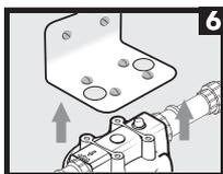
**6** Parafuse a tampa do filtro no suporte fixado na parede.
